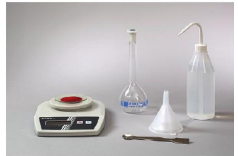
Doc. 13 Matériel nécessaire pour une dissolution.
